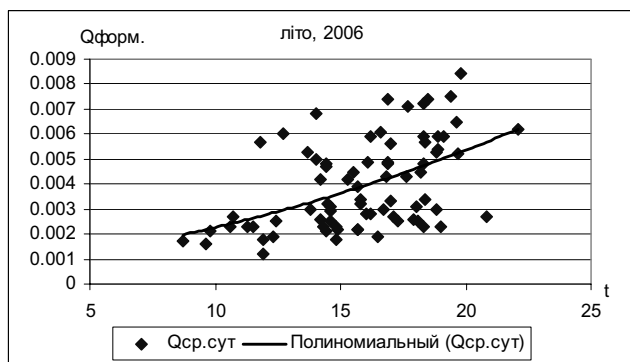
Рис. 2. Зв'язок температури повітря ( ^{\circ}\text{C} ) та концентрації формальдегіду ( \text{мг}/\text{м}^3 )
