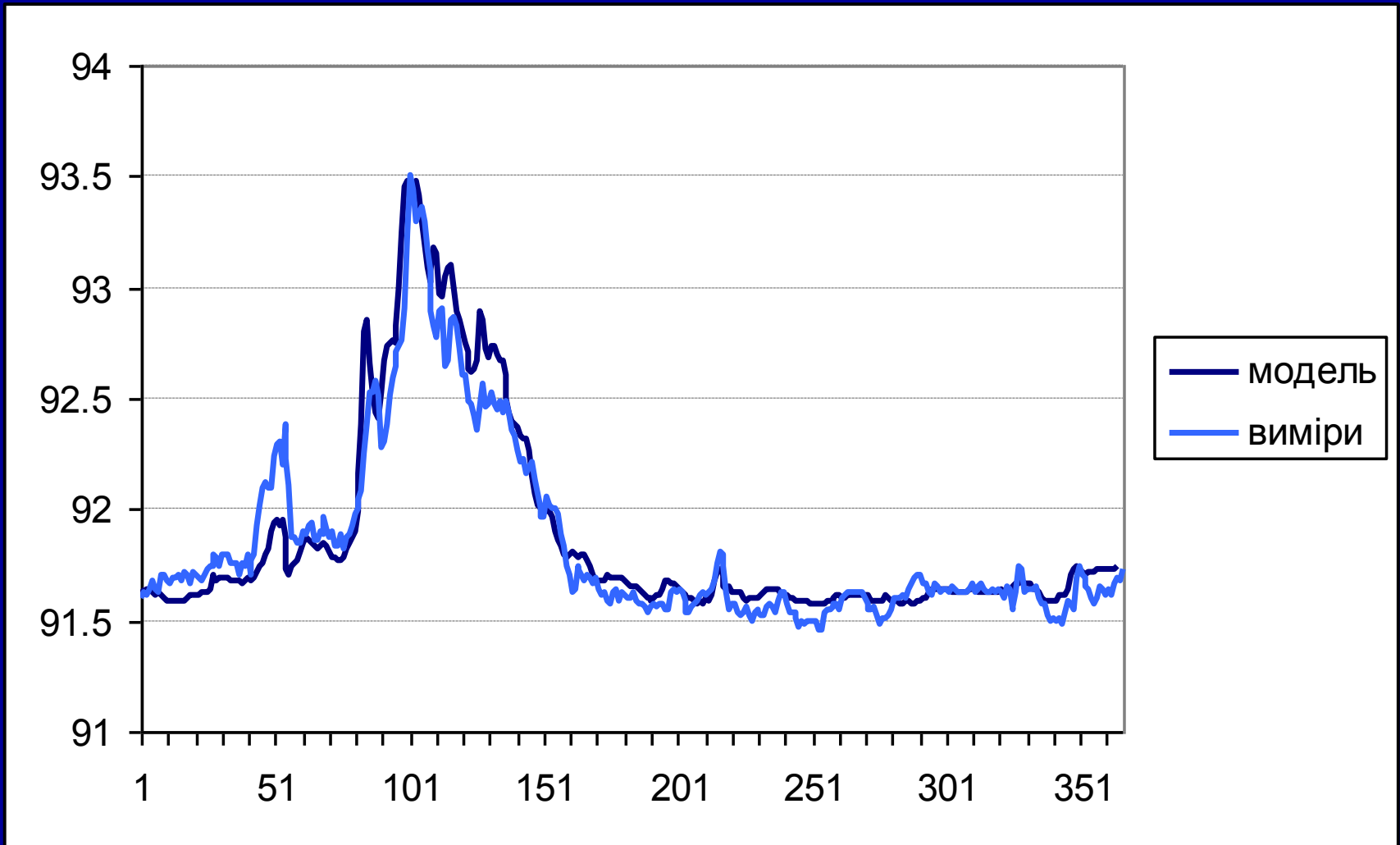
Калібрування 1D моделі: Виміряні та розраховані рівні води (мБС) на гс Київ у 2004 році в залежності від кількості днів від початку року.
